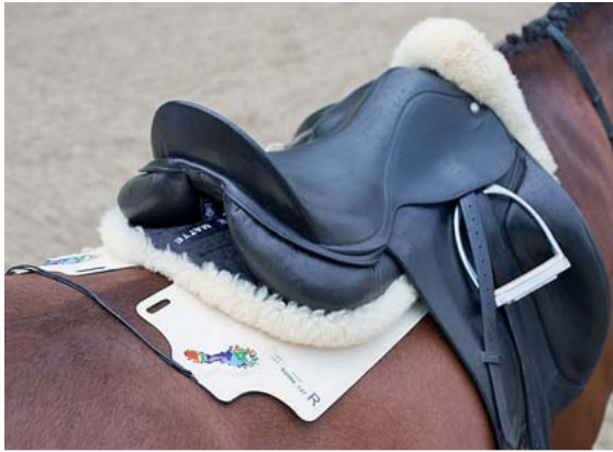
► Abb. 11 Verfahren bei der elektronischen Satteldruckmessung: Die Satteldruck-Messschabracke liegt hierbei zuunterst auf dem Pferderücken. Quelle: M. Haab, Vetsuisse-Fakultät, UZH
